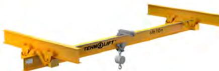
Кран-балки (разновидность подъемного крана мостового типа) представляют собой металлическую конструкцию, которая состоит из несущей балки, которая крепится к двум концевым балкам с закрепленными на них тележками, перемещающимися по подвесному рельсовому пути. Простота этого механизма позволяет эксплуатировать его даже в небольших помещениях.
