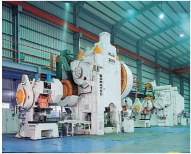
Forging Press 2500 ton & 1000 ton capacity
